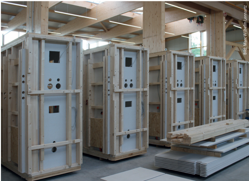
Das holzbasierte Badmodul. Über eine 3-D-Software kann die Ausstattung von drei definierten Typenmodellen individuell konfiguriert werden. Die Fertigung erfolgt nicht mehr auf der Baustelle, sondern über Holzbau-Partnerunternehmen in deren Werkhalle.
